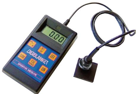
数码橡皮布检测仪可使橡皮布滚筒包衬量用数值来衡量。只需简单的操作，即可瞬间的检测出来。它的原理是利用磁性，来测试纸，胶皮，铝，塑料等非磁性体的厚度。
