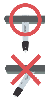
②作業は2人で行い、1人がデジニップの左右のセンサーをローラー間 (HARD面をメタルローラー側 / SOFT面をゴムローラー側) に置き、もう1人がローラーを動かして、センサーを中に差し込んで下さい。センサーはローラーに対して、 垂直 に入れて下さい。
